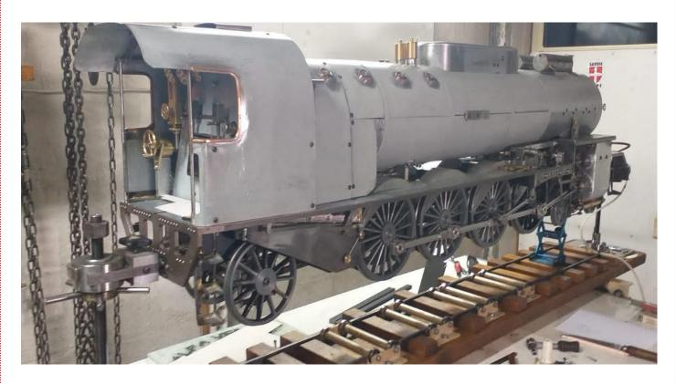
Voici une reproduction fonctionnelle d'une locomotive de configuration d'essieux 2, 4, 1 (2 essieux pour le boggie directeur, 4 essieux moteurs, 1 essieu pour le bissel arrière).
